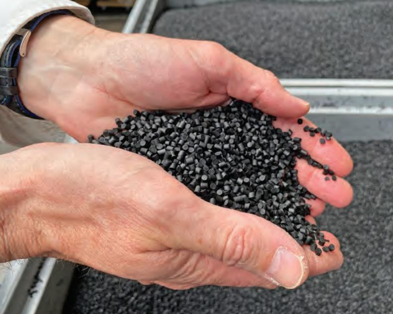
Compound (bille de plastique) permettant de réaliser les joints TPE. Seulement 3 % de billes de couleur permettent de produire des joints dans la teinte choisie.
