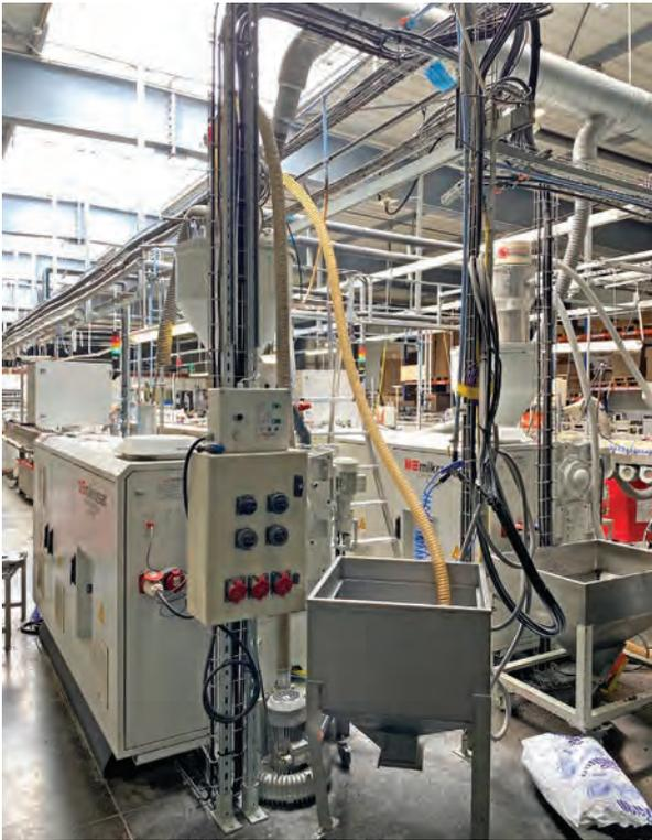
Chaîne de production de joints TPE avec système d'aspiration de compound et vis sans fin pour chauffer la matière à 200°.
